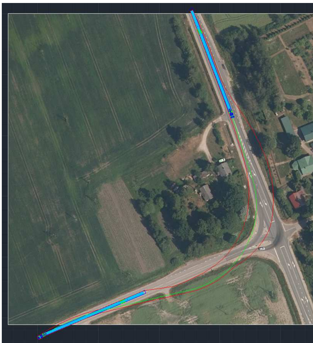
3.att. 95m gara transporta sastāva (ar aizmugurējo pārkari 18m) trajektorijas modelis a/c P108 un a/c P111 krustojumā. Trajektorija veidota pēc iespējas cenšoties neizbraukt ārpus a/c P108 brauktuves pagrieziņa ārmalā, kur ceļa malā ir grāvis.
